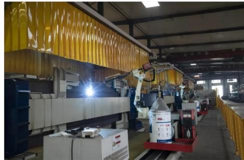
山东矿机通过导入川崎机器人进行机械自动化生产，单个部件生产车间人员由100人降至20人，已实现明显缩减；焊接完成率也由60%提高至85%，且一次合格率达到100%。不仅极大程度降低了人工成本，而且在保证生产良品率的同时，工作效率实现了大幅度的提升。
